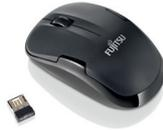
Die Wireless Maus W1200 verwendet modernste drahtlose 2,4-GHz-Technologie und mit einem optischem Sensor mit der hohen Auflösung von 1000 dpi bietet die Maus Ihnen die Präzision und Zuverlässigkeit, die Sie benötigen. Mit ihrem kompaktem Design und stillvollem schwarzen Finish eignet sich die kabellose Maus W1200 für alle Umgebungen und ist ideal für rechts- sowie linkshändige Bedienung.
